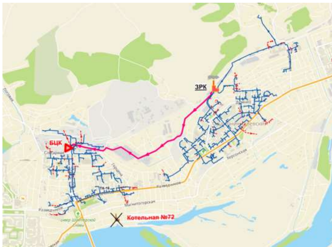
Рисунок 6.15 – Строительство тепловых сетей для переключения БЦК и котельной №72 на ЗРК
